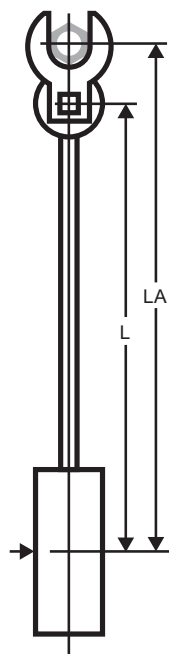
Figura 1 - Ajuste do torque ao utilizar um Torquímetro. Ajuste do torque = Torque desejado * L / LA
